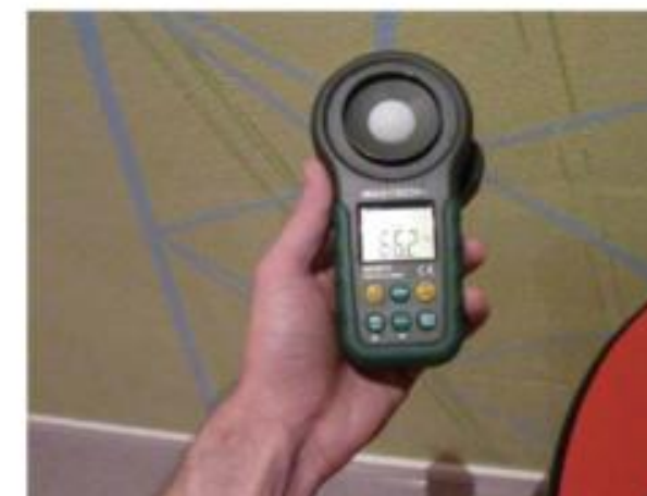
室内照度测量
